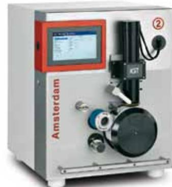
部設備が、機器内に統合されるので、新しいタック・オー・スコープは以前の機種よりコンパクトになりました。測定および練りローラーには、試験機の再現性を高めるために自動リフト・システムが追加されました。また、測定データ分析も、今後は、オフラインで行なうことができます。新しいGST+は、GST1とGST2の機能が組み合わされています。
