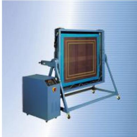
私たちの真空コピー・フレームは、ミディアム・フォーマット、上塗りを施したスクリーン・フレームの水平・垂直の複写のために設計されました。私たちの SKT TABLETOP COPY FRAME は水平の複写に使用され、次のサイズにおいて利用可能です：
