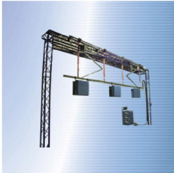
JUMBOCOP LARGE SCREEN COPY UNIT は多数の AKTICOP S MH-INSTANT COPY LAMP を装備しており、完全に大きなフォーマット・スクリーンを照射することを目的として製造されました。ユニットはすべてのタイプの UV 感光フィルムを照射することができます。
